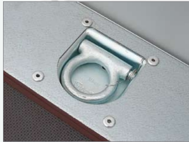
Serie: Verzurröse im Rahmen integriert - Hochlader
