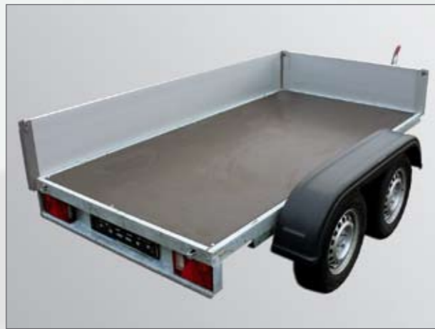
Serie: Bordwände allseitig abnehmbar - Tieflader
