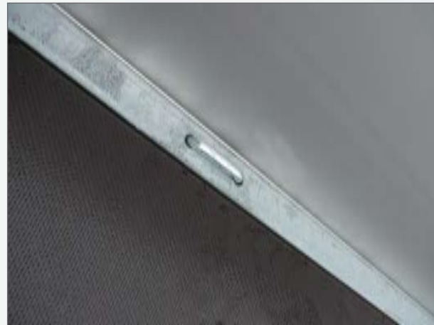
Serie: Verzurröse im Rahmen integriert - Tieflader
