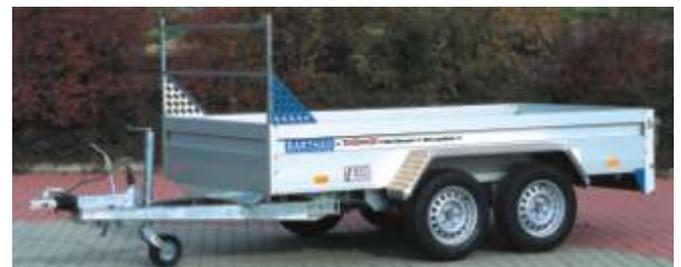
**QL 2702** mit Zubehör: **H-Galerie 600mm hoch gesichert mit Lochblechen** gegen unbeabsichtigtes Herausziehen oder Kippen. Das obere Rohr ist drehbar gelagert und passt sich der Ladung an. Aluminium-Riffelblechkotflügeln statt Blechkotflügeln.
