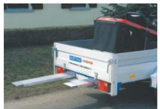
**QL 2702** befahrbar durch **Aluminium-Rampen Typ RL**. 2000 mm lang, 220 mm breit, Tragkraft lt. **Prospekt 0.2**. Die Rampen haben eine griffige Lauffläche und sind durch die Bolzenarretierung gegen Abrutschen gesichert. Zum Transport werden die Rampen beim **QL 2702** in einer Halterung unter der Ladefläche eingeschoben.
