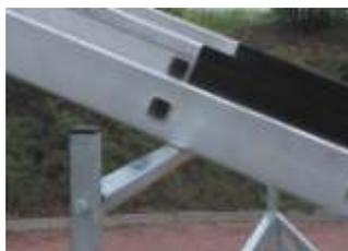
**H-Galerie 600mm hoch** gesichert mit stabilen Lochblechen gegen unbeabsichtigtes Herausziehen oder Kippen. Das obere Vierkantrohr ist drehbar gelagert und paßt sich dem Ladewinkel automatisch an. Beschädigungen an Aluminiumleitern werden vermieden.
