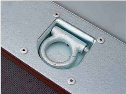
Serie: Verzurrösen im Rahmen integriert - Hochlader
