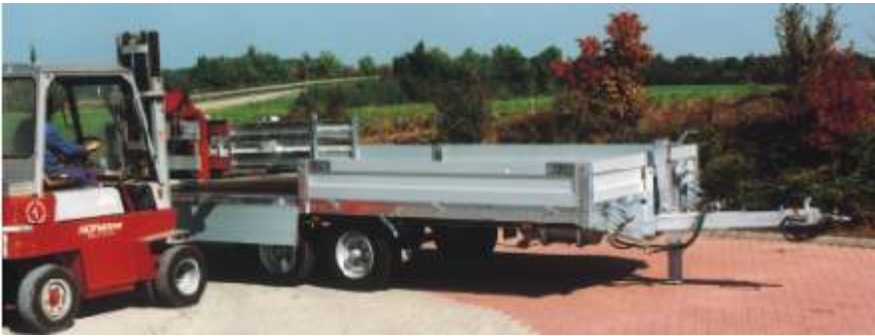
Typ LH mit Zubehör: Bordwände auf 400 mm gekürzt.
