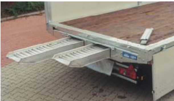
Typ LHD serienmäßig mit Aluminium-Auffahrampen unter dem Anhänger eingeschoben. Die Ladungssicherung erfolgt durch das serienmäßige Zurrprofil TOPZURR23 mit versenkten Anbinderingen nach DIN 75410.
