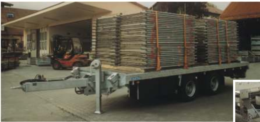
Typ LHD 18000 ohne Bordwände, serienmäßig mit der neuen Ladungssicherung TOPZURR23 und mit Aluminium-Auffahrampen unter dem Anhänger eingeschoben. Mit Luftfederung, zwillingsbereift.
