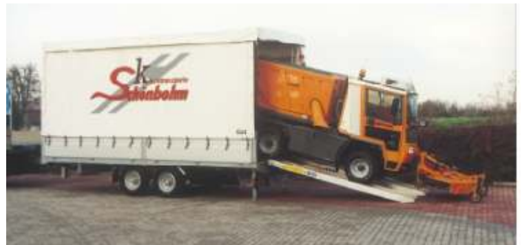
Durch die flache Auffahrt ist der Anhänger Typ LHD gut befahrbar.
