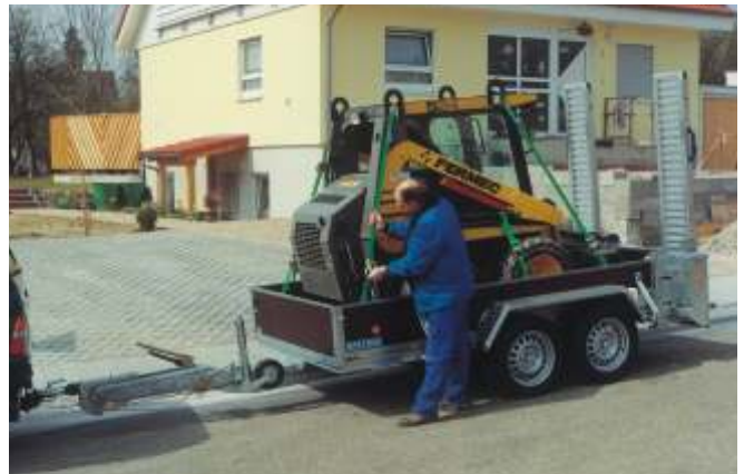
GTB 3502 ausgerüstet mit: Multiplex-Bordwänden 400 mm hoch, höhenverstellbarer Auflaufbremse mit LKW-DIN-Zugöse, verstellbar von 400 bis 1100 mm Anhänghöhe (auf Wunsch mit Kugelkupplung).
