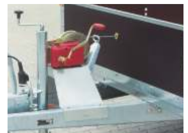
Seilwinde , 900 kg Zugkraft, mit Abrollautomatik, Windenbock mit Umlenkung, zentral auf den V-Zughaken montiert, Zugseil durch die Stirnwand geführt.
