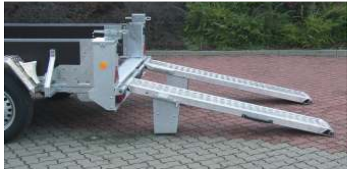
Zwangsabstützung für Aluminium-Auffahrrampen (nur bei GTB). Keine Kurbelstützen mehr erforderlich. Schnellere Bedienung und Fahrbereitschaft. Stützen anheben kann nicht mehr vergessen werden.
