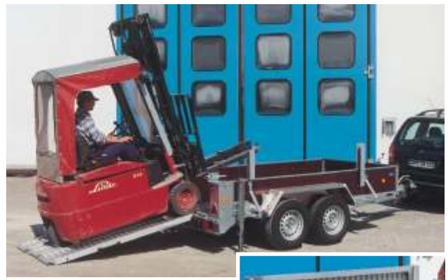
GTA 2702 serienmäßig mit Teleskopstützen , Tragkraft 1500 kg/Stk. Zubehör: zusätzliche 3. Auffahrrampe , platzsparend in spezieller Halterung auf den Bordwänden eingesteckt. Ermöglicht problemloses Verladen von dreirädrigen Fahrzeugen.
