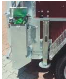
Werkzeugbox aus verzinktem Stahl zum Verstauen von Werkzeug und Gurten (nur bei GTB). Teleskopstütze , mit Sperrbolzen arretierbar, Feineinstellung über Handkurbel, Tragkraft 1500 kg/Stk.
