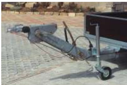
Problemloses Wechseln zwischen verschiedenen Zugfahrzeugen mit unterschiedlichen Anhänghöhen durch höhenverstellbare Auflaufbremse mit LKW-DIN-Zugöse (auf Wunsch mit Kugelkupplung zum Wechseln).
