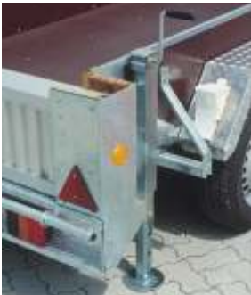
Geräuschkämmung an der Rampenhalterung durch serienmäßig montierte Kokosmatte (nur bei GTA). Teleskopstütze , mit Sperrbolzen arretierbar, Feineinstellung über Handkurbel, Tragkraft 1500 kg/Stk.
