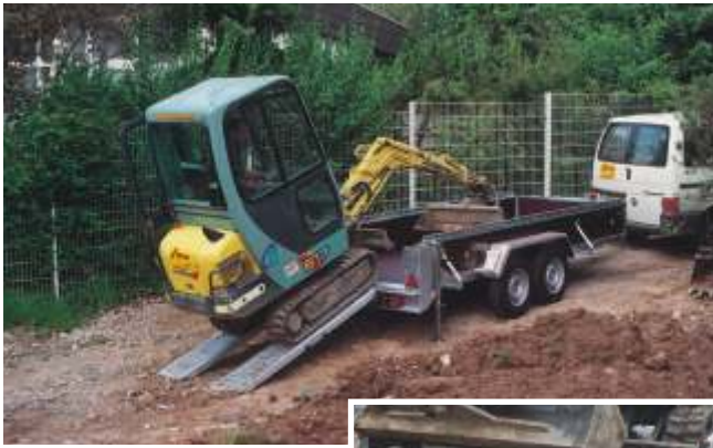
GTA 3502 in Länge 4050 mm: serienmäßig mit Gurtleiste als zusätzliche Stabilitätsreserve. Zubehör: Baggerlöffelablage , an der Stirnwand montiert.
