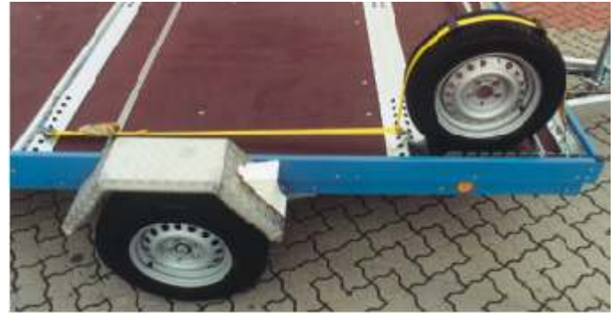
PKW-Befestigungssystem bestehend aus einer verstellbaren Reifenanschlagschiene vorne und 2 quer verschraubten Zurrleisten. Dazu benötigt man dann noch die Spezialspanngurte für PKW mit Ratsche und 3 Profilhaken. Pro Rad wird ein Spanngurt benötigt. Es sollten alle 4 Räder so gesichert werden.
