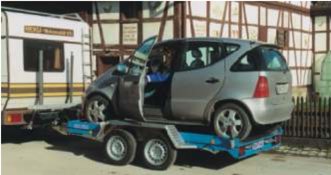
U 2002 mit Zubehör: Alu-Auffahrampen in einer Halterung unter der Ladefläche einschiebbar. Transportsicherung durch Excenterklemmverschluss, dadurch ist ein absolut geräuschfreier Transport gewährleistet.
