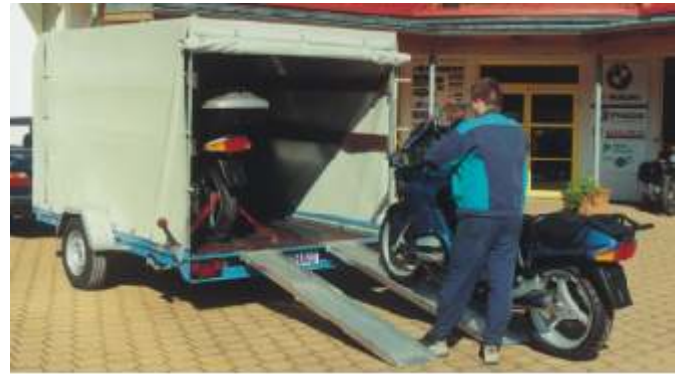
U 1601 in Fahrschulerausrüstung mit Dachgestell und Plane, Ladehöhe 1650 mm. Mit Motorradtransportausrüstung können auch Fahrschulmotorräder bequem transportiert werden. Durch die Breite des Anhängers können auch zwei große Motorräder verladen werden.
