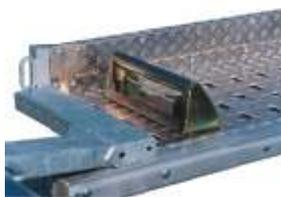
Verstellkeile zur Ladungssicherung, über die gesamte Anhängerlänge verstellbar. Gurtösen, am Rahmen angeschweißt.
