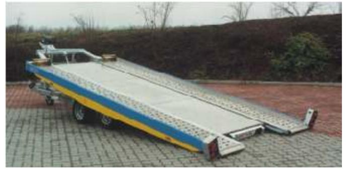
**AH 3002 mit Zubehör:** 3-teiliger **Alu-Riffelblech-Zwischenboden**. **Elektrische Seilwinde** mit Fernbedienung (1000 oder 1500 kg Zugkraft) an stufenlos verstellbarem Windenbock. Anschluß 12 oder 24 Volt möglich.
