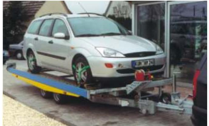
**AH 3002** serienmäßig. **Zubehör:** Seilwinde, 900 kg Zugkraft, Windenbock verstellbar. Das zu transportierende Auto ist zusätzlich gesichert mit je einem Rad-Sicherungsgurt. Ein Rundgurt (Längenverstellung durch Spansschloß) wird über das Rad gestülpt und mit einer Ratsche nach unten gespannt.
