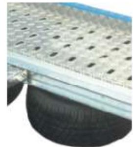
Zubehör: Ersatzrad mit Halterung rechts unter der Ladeischiene montiert.
