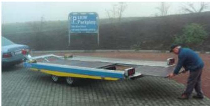
**AH 3002** mit Zubehör: 3-teiliger Zwischenboden aus 21 mm Multiplex-Siebdruckplatten, von hinten einschiebbar und Seilwinde, 900 kg Zugkraft, Windenbock verstellbar.
