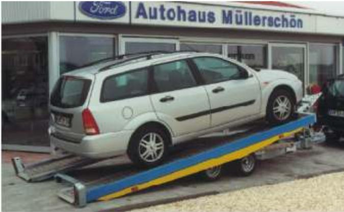
**AH 3002** serienmäßig in **blau-gelbem Design**, mit **2 Verstellkeilen** zur Ladungssicherung und **schwerem Stützrad**. Der Anhänger überzeugt durch eine große freie Deichsellänge und einen extrem flachen Auffahrwinkel.
