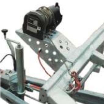
Elektrische Seilwinde mit Haken und Fernbedienungskabel (1000 oder 1500 kg Zugkraft) an stufenlos verstellbarem Windenbock. Anschluß 12 oder 24 Volt möglich.
